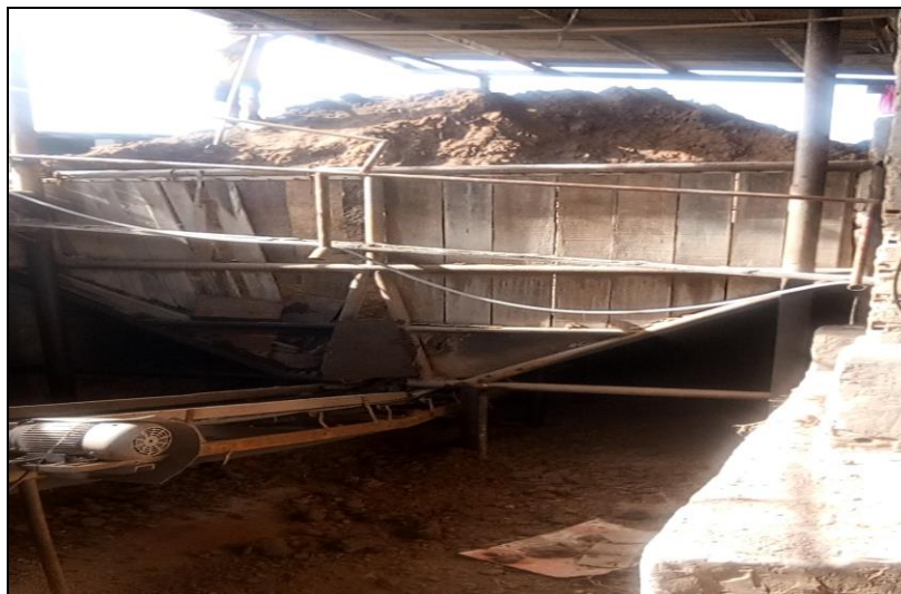
Figura 3 - Fotografia do Caixão misturador, processo inicial de fabricação
