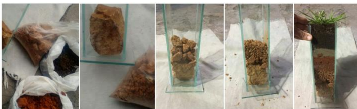
Figura 3: Processo de construção do perfil de Solo, a figura mostra o processo de preenchimento de sedimentos dentro do perfil de vidro.
